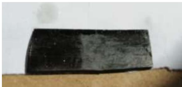
Рис. 6 Образец номер три после нанесения цинка
