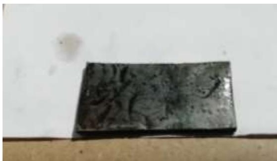
Рис. 4 Образец номер один после нанесения цинка
