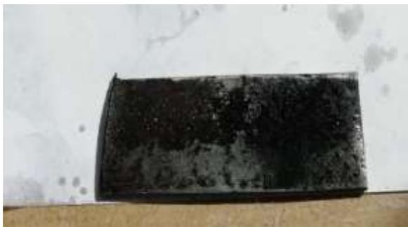
Рис. 5 Образец номер два после нанесения слоя цинка
