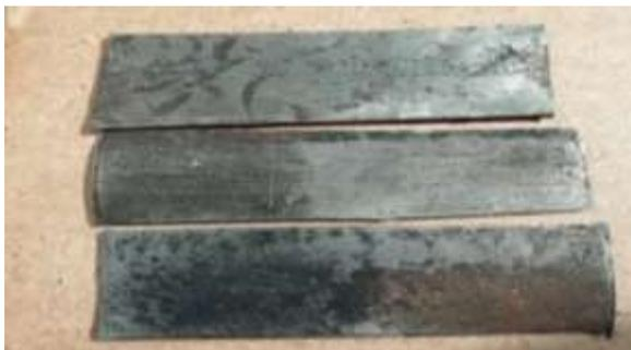
Рис. 7 Образцы после нахождения в соевом растворе в течении одних суток.
