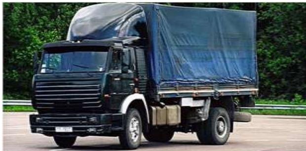
Рис.2 На автомобиле КамАЗ установлен обтекатель
